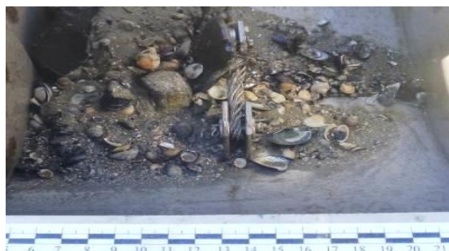
Рисунок 1.3.7 – Биогенно-терригенный грунт с перемытым грязевулканическим материалом (обломки пород),
